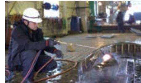
船の部材となる鋼板を曲げる加工を行います。曲げ加工にはぎょう鉄という作業があり、ガスバーナーによる加熱と水による冷却を繰り返しながら、職人が一枚ずつ手作業で曲げていきます。このぎょう鉄作業には、長年の経験と勘を必要とする熟練の技が求められます。
