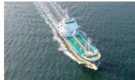
ほぼ完成状態になった段階で、実際に海上を試験的に航行する試運転を行います。ここでは船の速度や旋回などの各性能や各機器の作動状況を入念に確認し、最終的な調整を行います。
