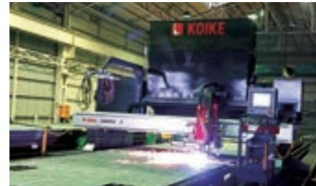
船の部材となる鋼板を切断する加工を行います。切断加工はNCプラズマ切断機で自動的に切断が行われます。この切断機により、無駄なく正確なサイズに鉄板が切断されています。
