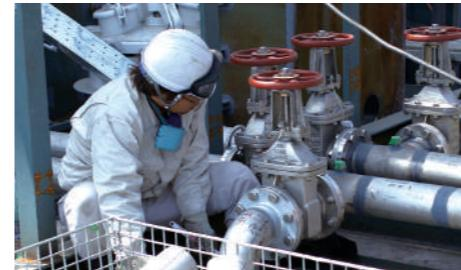
進水した船は桟橋に係留され、義装工事が行われます。義装とは船の配管や機関室、居住区、電気設備、各機器などを仕上げていく工程です。様々な担当分野の作業員が集結し、現場は次第にあわただしくなり、作業は大詰めをむかえます。
