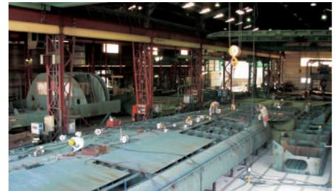
切断・曲げ加工された部材をブロックに組み立てていく工程です。ブロックとは、船体をいくつかの区画に分割したもので、溶接やクレーンを使って小さな部材から徐々に大きなブロックに組み立てられていく様子はまるで巨大なプラモデルを作っているかのようです。
