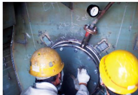
タンクや配管の水密性や耐圧性を調べるために水圧試験や気密試験を行います。
