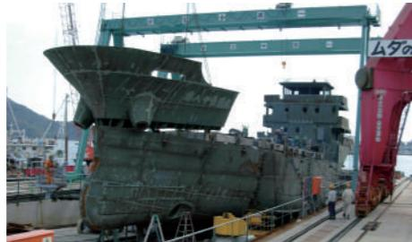
ブロックを船台でつなぎ合わせて船体を組み立てていく工程です。いくつものブロックが大型クレーンで吊り上げられ、搭載していく様子は圧巻です。ここでは船体に塗装も施され、徐々に船らしい姿になっていきます。
