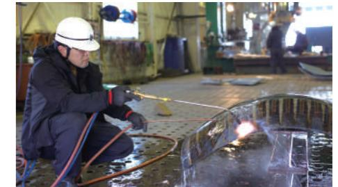
船の部材となる鋼板を曲げる加工を行います。曲げ加工にはぎょう鉄という作業があり、ガスバーナーによる加熱と水による冷却を繰り返しながら、職人が一枚ずつ手作業で曲げていきます。このぎょう鉄作業には、長年の経験と勘を必要とする熟練の技が求められます。
