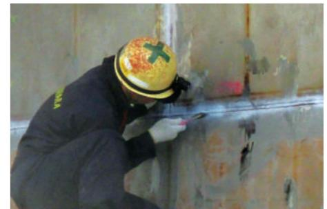
ステンレスタンクの溶接部表面の微細な欠陥を特殊な検査液で着色することで見つけ出す検査を行います。
