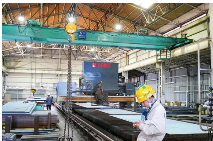
早い時期に導入した鋼板NC切断機と型鋼NC切断機
