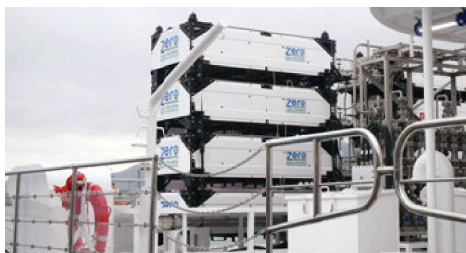
水素燃料を格納する着脱式タンクモジュール
